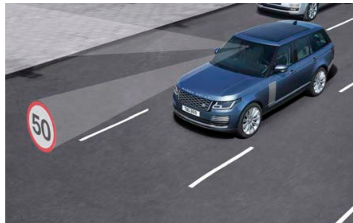
Riconoscimento dei segnali stradali con limitatore di velocità adattivo
